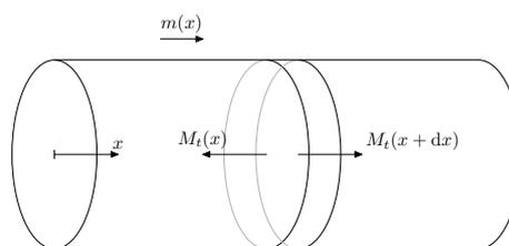
Figura 2: Pares actuando sobre una viga sometida a torsión variable.
