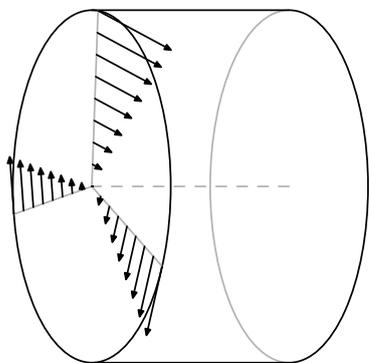
Figura 1: Tensiones tangenciales en un eje circular sometido a torsión
